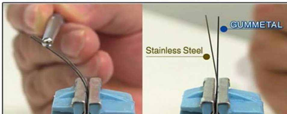
Abb. 01: GUMMETAL ermöglicht die stabile Drahtbiegung und besitzt gleichzeitig hervorragende Rückfederungseigenschaften
