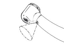
将手机安装到连接器，然后打开牙科综合治疗台的主开关。踩下踏板，确认 LED 灯是否点亮。
