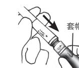
握住套帽，将手机笔直推到连接器上，直至紧固到位。
