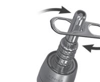
用手指将灯罩装回，然后用管帽工具的方形孔拧紧。
