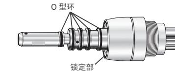
如果开始从连接处漏气或漏水，请更换 O 型环。更换后，在器械的 O 型环上涂抹少量森田指定喷液。
