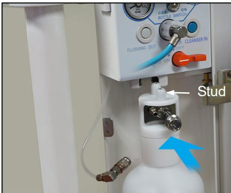
(9) Richten Sie die Aufnahme am Deckel an der Rille aus und drücken die Flasche wieder vollständig ein. Schließen Sie dann den weißen Luftschlauch wieder an.
