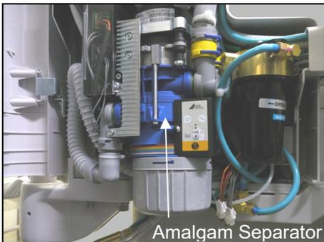
In Ländern mit einem Gesetz bezüglich der Verwendung eines Amalgam-Abscheiders kann SPACELINE EMCIA mit einem internen Amalgam-Abscheider ausgestattet werden.
