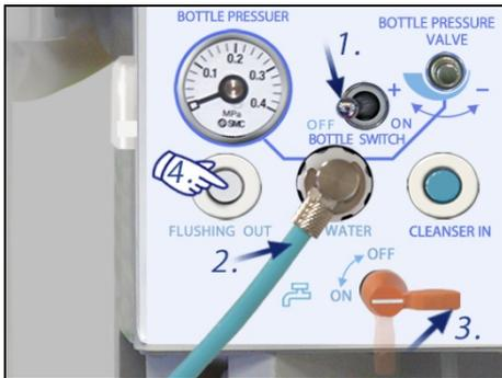
1. Stellen Sie sicher, dass der BOTTLE SWITCH ausgeschaltet ist.
