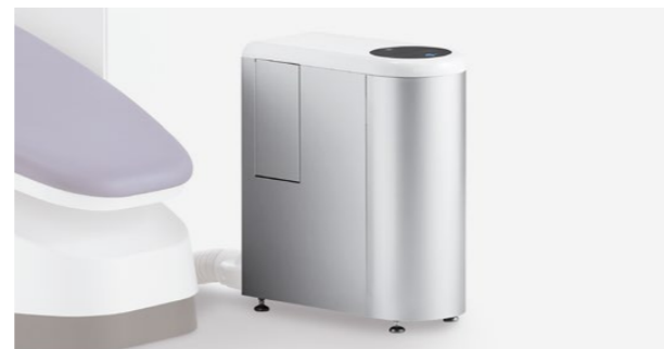
クリーンウォーターシステム リセオ (オプション) 水の衛生環境を維持するため、送水過程で失われた有効塩素を追加注入することで適正な遊離塩素濃度まで高めて、歯科用ユニット内の水の清浄を保ちます。
