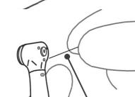
使用提供的喷水孔通针清洗喷水孔，然后在流动的水源下冲洗手机。
