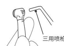
清洗后，擦干手机上的水分，然后使用三用喷枪或气枪吹干手机内残留的水分。
