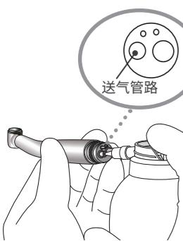
将喷嘴插入送气管路的手机连接部，牢牢握住手机，然后喷射 2 秒。
