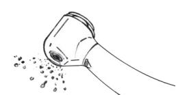
将手机与软管连接。让手机工作至少 15 秒，排掉机头多余的润滑油，然后用纱布擦拭干净。将手机从软管上拆下。
