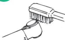
从手机卸下钻针，然后将手机从软管上拆下。在流动的水源下用软刷清洗切削及其他碎屑。
