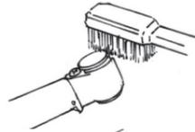
从手机上卸下钻针,然后将手机从软管上拆下。在流动的水源下用软刷清洗切削及其他碎屑。
