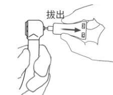
慢慢地拔出夹钳力试验棒,直至能够看到凹槽。
