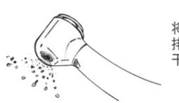
将手机与软管连接让手机工作至少 15 秒,排掉机头多余的润滑油,然后用纱布擦拭干净。将手机从软管上拆下。
