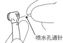
使用提供的喷水孔通针清洗喷水孔,然后在流动的水源下冲洗手机。
