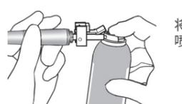
将喷嘴插入手机连接部,牢牢固定,然后喷射 2 秒。
