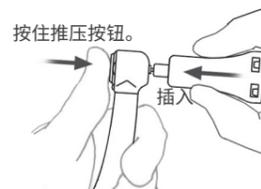
用力按住推压按钮,同时笔直插入夹钳力试验棒。
