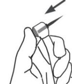
用力按住推压按钮,同时将钻针插到底。
