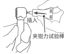
将卡盘试验棒笔直插入,直至接触到卡盘机构。
