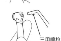
清洗后,擦干手机上的水分,然后使用三用喷枪或气枪吹干手机内残留的水分。
