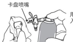
用纱布垫在机头部,将卡盘喷嘴尖端插入钻针插孔,喷射 2 秒。
