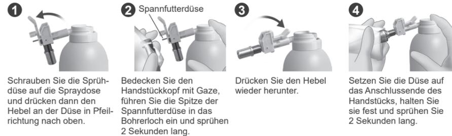
**1** Schrauben Sie die Sprühdüse auf die Spraydose und drücken dann den Hebel an der Düse in Pfeilrichtung nach oben.
