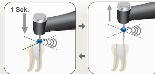
Drücken Sie die Feile rund 1 Sekunde nach unten, um zu verhindern, dass sich die Feile herausdreht und ziehen Sie sie dann nach oben. Wiederholen Sie diesen Vorgang, bis die Anzeige, wie auf der Abbildung rechts dargestellt, die Position 0,5 erreicht. Wenn die Anzeige 0,5 erreicht, wird die Feilenrotation automatisch gestoppt.
