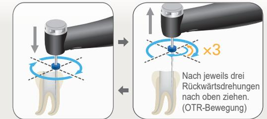
Bewegen Sie die Feile langsam weiter, um mit der Wurzelkanalaufbereitung zu beginnen. Wenn die Feile beginnt, sich in die entgegengesetzte Richtung zu drehen, ziehen Sie die Feile schnell heraus und wiederholen Sie den Vorgang. Wenn die Anzeige den Sollwert 1 erreicht, wird die Feilenrotation automatisch gestoppt.
