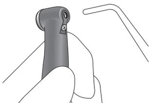
(2) Utilizzare una siringa a tre vie ecc. per eliminare l'umidità residua all'interno del contrangolo.
